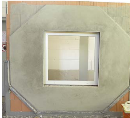
Bild 7. Ansicht des Prüfkörpers mit PHLz6-0,5 im Prüfraumen vor den Untersuchungen
