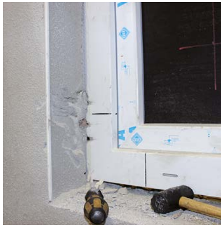
Bild 13. Laibung mit Armierungsputz nach Ende der normativen Versuchszeit für die Widerstandsklasse RC2 in PHLzB6 - 0,5 (Großkammerziegel) Wanddicke 365 mm
