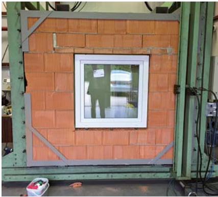
Bild 6. Ansicht des Prüfkörpers mit PHLzB6-0,9 im Prüfraumen vor den Untersuchungen
