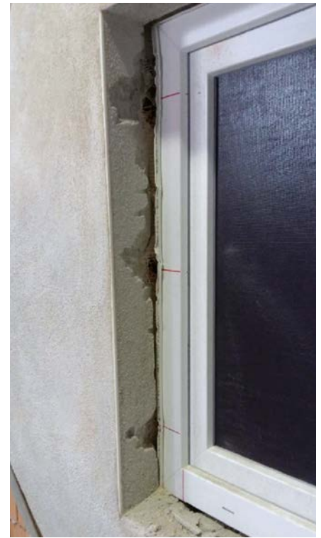
Bild 14. Laibung mit Armierungsputz nach Ende der normativen Versuchszeit für die Widerstandsklasse RC2 in PHLzB8 - 0,65 (Kleinlochung) Wanddicke 365 mm
