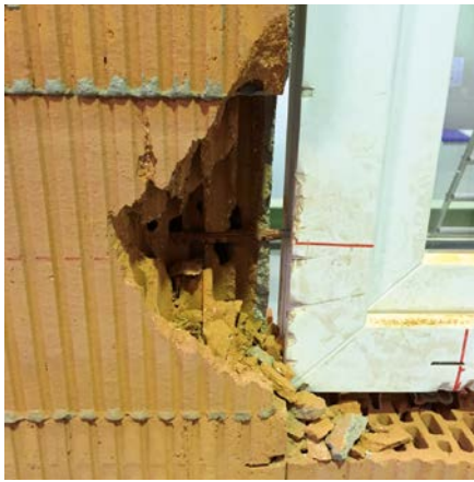
Bild 12. Wandöffnung nach Ende der normativen Versuchszeit für die Widerstandsklasse RC2 in PHLzB6 - 0,9 - Wanddicke 240 mm
